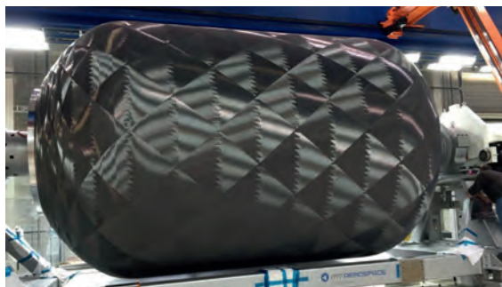
Der Demonstrator des CFK-Boosters (oben) während des Wickelprozesses beim DLR-ZLP und nach dem Bersttest in der Testgrube (oben rechts) der Materialprüfungsanstalt (MPA), Stuttgart.
