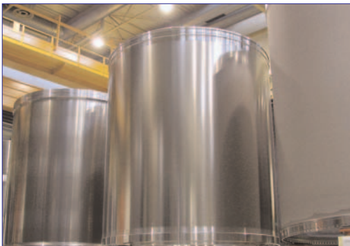
Segmente der ARIANE 5-Boostergehäuse in den Fertigungshallen der MT Aerospace AG in Augsburg
