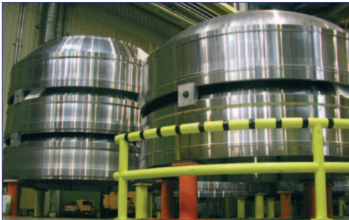
Dome für ARIANE 5-Boostergehäuse bei der MT Aerospace AG
