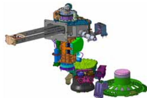
Das Probenaufbereitungs- und -verteilungssystem (SPDS) für den ExoMars Rover setzt sich aus vier Mechanismen von OHB zusammen / The Sample Preparation and Distribution System (SPDS) for the ExoMars Rover is made up of four mechanisms by OHB
